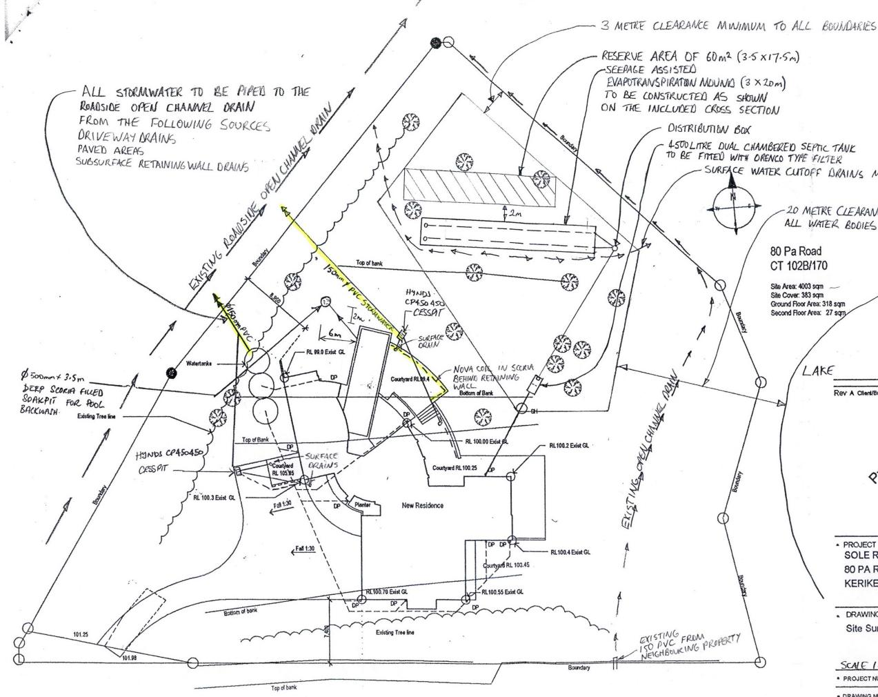
SITE PLAN SHOWING STORMWATER + EFFLUENT DISPOSAL SYSTEMS
